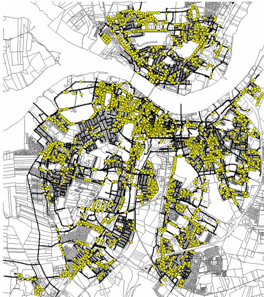
Figur 1. Eksempel på resultat af modelberegning af afløbssystem. Af figuren fremgår, hvilke dele af afløbssystemet der overbelastes hvert 100. år (gule prikker) med det nuværende nedbørsmønster.
