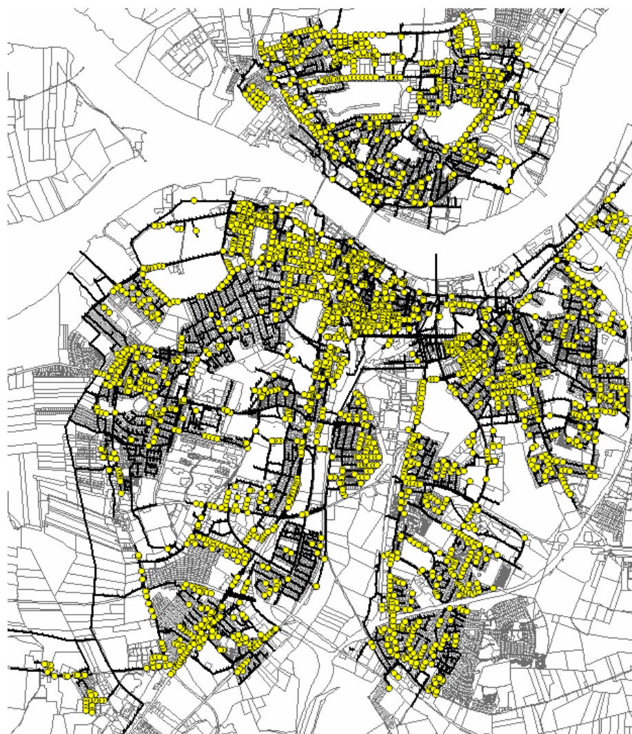
Figur 6. Oversigt over, hvor i Aalborg det kan forventes, at der vil ske overbelastning af afløbssystemet, når der kommer en 100-års (gule prikker) hændelse.
