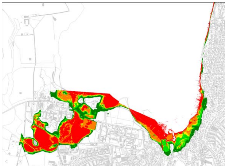
Figur 3: Angivelse af forskellige risikozoner for et kystområde. De røde områder markerer områder, der i dag oversvømmes hyppigt, mens de mørkegrønne områder markerer områder, der ud fra en konservativ vurdering af stigende havvandstand vil blive oversvømmet en gang hvert 100 år i år 2090.
